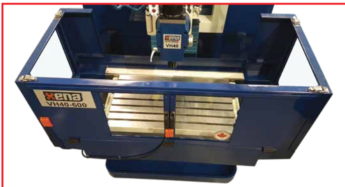
Protection contre les projections de copeaux. Protection against chips projection.
